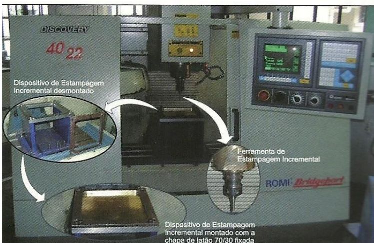
Figura 5 - Equipamento CNC adaptado para o processo de estampagem incremental. Fonte: Fritzen et. al, (2011)
